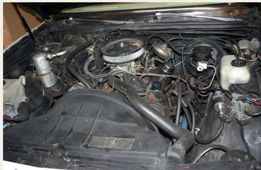
Et eller andet sted nede under slanger og ledninger gemmer sig en 3,8 liter V6 motor, som yder noget i retning af 105 hk.
