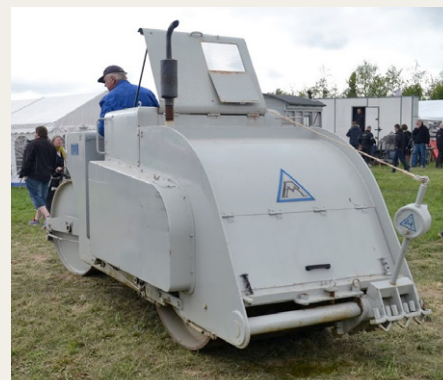
Gammel tromle fra Pedershaab Maskinfabrik. Byggeår 1950, model TA-7 og har en 3 cyl. Ruston motor. Har kørt for Karlebo Kommune fra 1950 til 1980, hvorefter den blev renoveret i 1998.
