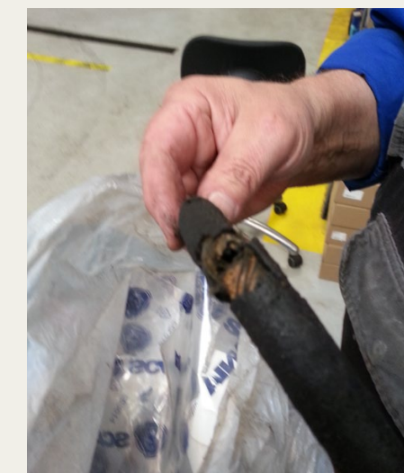
En af de slanger som leverede luft til gearkasse og døre.
