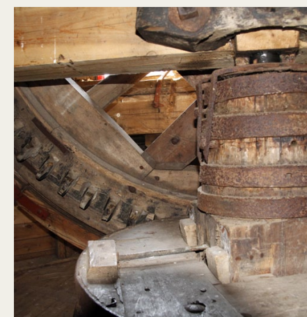
Her er en del af udvekslingen, hvor vingernes bevægelse overføres til den lodrette aksel ned igennem møllen.
