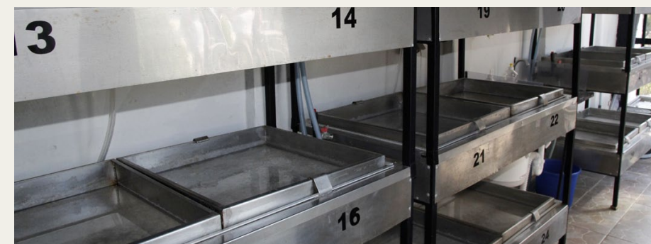
Det fine salt blev inddampet i masser af flade bakker med konstante temperaturer.
