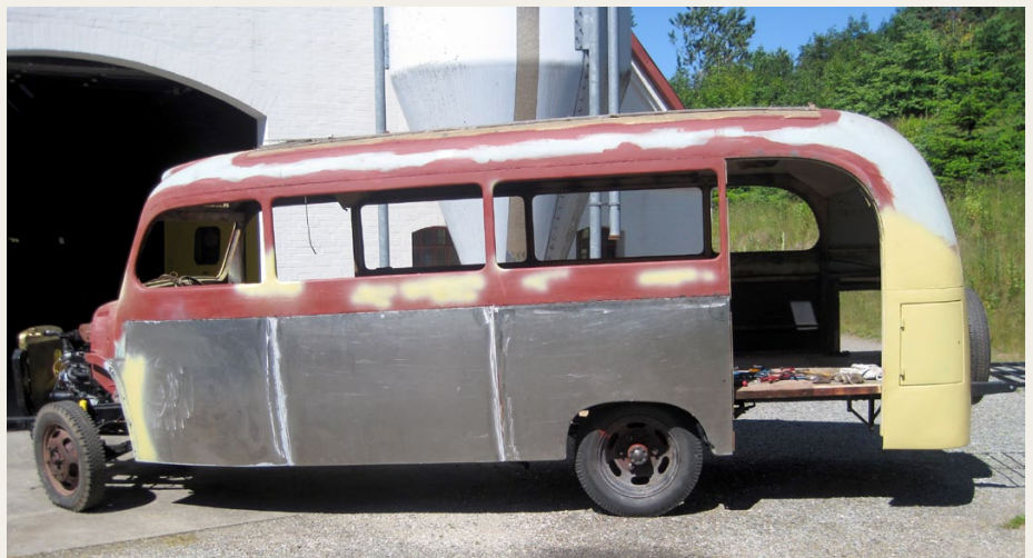
Så er karosseriet blevet genforenet med chassisrammen, og der kommet nye plader på siderne
