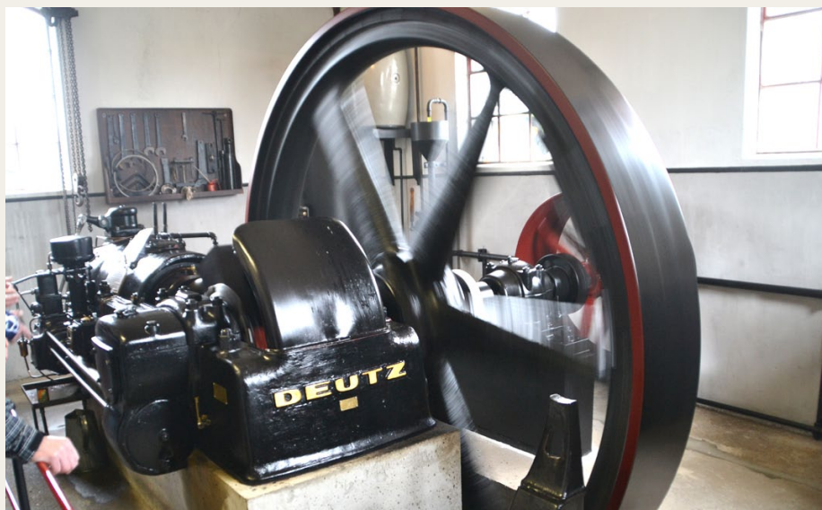
En af Dansk Motorsamlings perler er denne imponerende vandretliggende éncylindrede dieselmotor, som har et slagvolumen på hele 67.000 ccm. Motoren, som yder 80 hk, har fra ny i 1930 trukket et el-anlæg under Aalborg El-forsyning. Senere har den trukket et savværk i nærheden af Ebeltoft.
