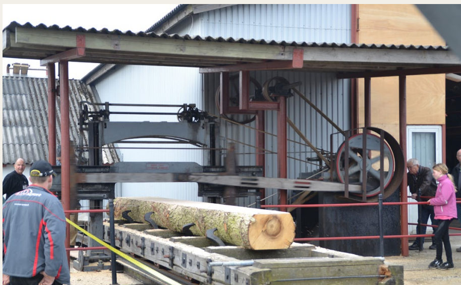
Den store bloksav trækkes af en to-cylindret Buch motor på 50 hk
