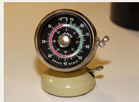
Et instrument til måling af friktion via en bremseprøve er et uundværligt værktøj for en bilinspektør.
