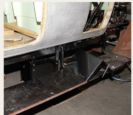
Det kan være lidt svært at se, men under bunden af bilen finder vi batterikassen, mens dækslet dertil ligger på trinbrættet.
