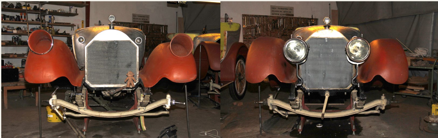
Her ser man tydeligt forskellen på de to biler. Til venstre ser vi de karakteristiske Pierce Arrow lygter indbygget i forskærmene. Til højre de mere traditionelle, separate forlygter fra det engelske firma CAV.
