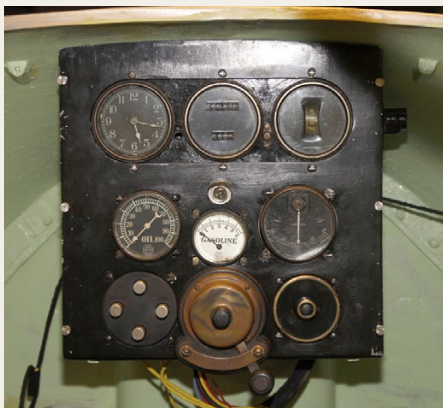
Instrumenterne i de centerplacerede instrumentpaneller er monterede. Nu mangler bare de at blive slutet til.
