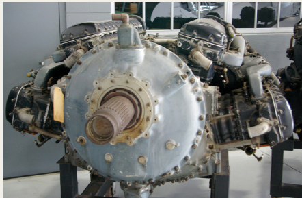
1940 Allison 24 cylinder vandkølet W-motor på 56 liter og 2600HK ved 3000 omdr./min. Motoren er i bund og grund en sammenbygning af to stk 12 cylinder motorer med hver sin krumtap og koblet til en fælles propelaksel. Vægt 1180Kg.
