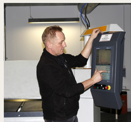
Henrik Lyngby demonstrerer, hvordan man programmerer den CNC styrede svingpresse.
