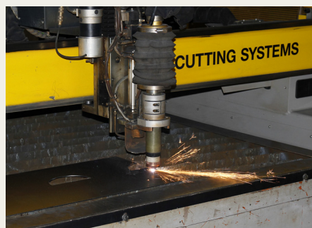
En plasmaskærer en forholdsvis billig og enkel metode til at skære avancerede figurer, men den har sine begrænsninger.
