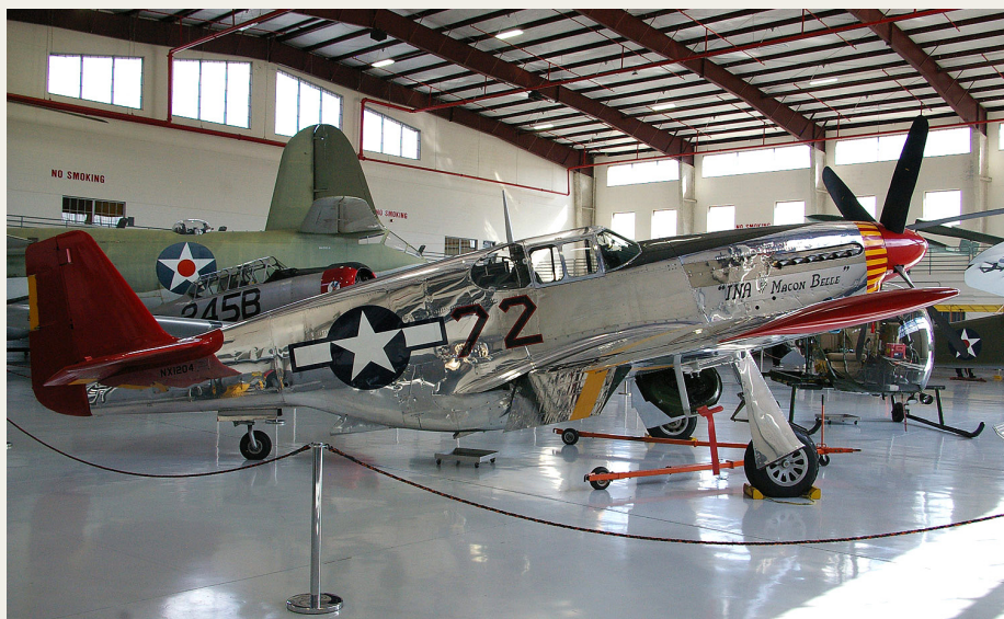
1944 North American P-51C. Én af kun fire tilbageværende af denne type. Udstyret med en Packard-bygget 12 cylinder Rolls Royce Merlin motor på 1550HK som giver den en marchhastighed på 480km/t.
