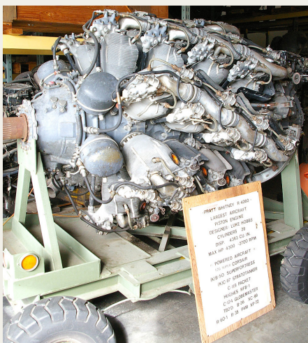
Pratt & Whitney R 4360 28 cylinder stjernemotor på 71,5 liter, 4300HK ved 2700omdr./min.
