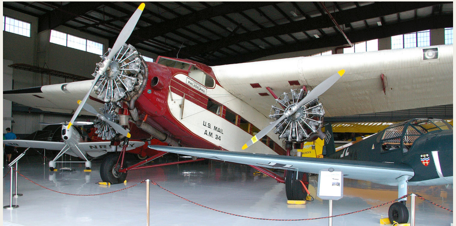
1929 Ford 5AT Tri-motor. Tre Pratt & Whitney motorer på hver 420 HK, march hastighed 145km/t. Det første kommercielt succesfulde trafikfly.
