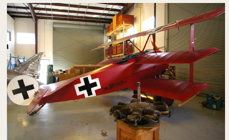
1917 Fokker DR-1 Tri-plane stående i restaurationsværkstedet afventende udskiftning af motoren med den rotationsmotor, der ses i forgrunden. I rotationsmotoren er det hele motoren, der roterer omkring den fastgjorte krumtapaksel. Den store roterende masse skaber en kraftig gyroskopeffekt, hvis resultat er en ustabilitet under flyvning, som i værste fald kunne være fatal for den uerfarne pilot. Flyet er malet i samme farveskema som det fly, den berømte Manfred von Richthofen – Den Røde Baron - fløj.
