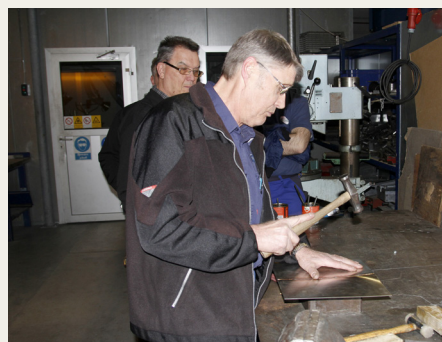
Hans svinger hammeren og strækker svejsningen så meget, at pladen igen bliver lige.
