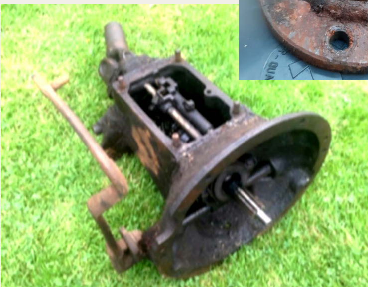
En sød lille 3 trins gearkasse, hvor det første gear er usynkroniseret, andet og tredje gear var synkroniseret, det var rimeligt moderne på den tid.
