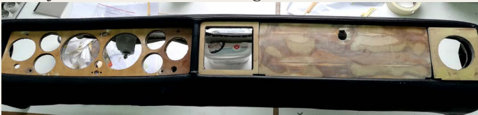
Nyt læder på instrumentpanel/midterkonsol og prøvesamlet.
