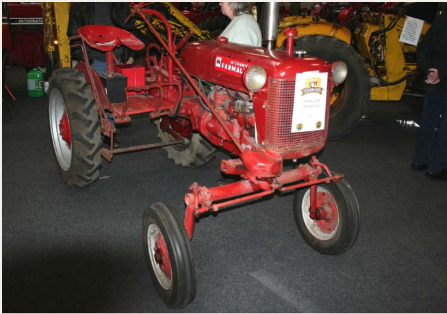
IH's mindste taktor, denne en 1950 Farmall Cub „CultiVision“, karakteristisk med assymetrisk opbygning med førerplads modsat motoren.
