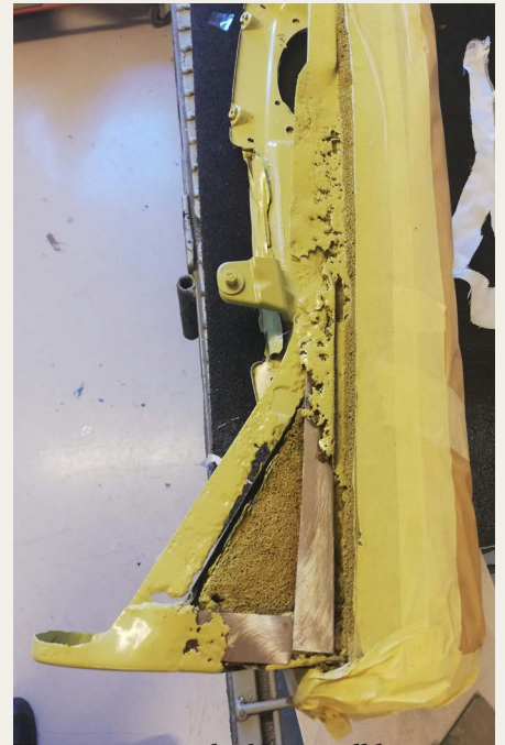
Instrumentpanelet blev sandblæst og repareret m. bla. glasfiber
