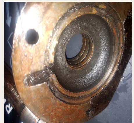
Skive/kulskive -udrykkerleje De grove gevind er til speedometerdrevet.
