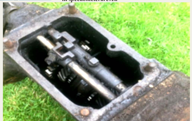
En sød lille 3 trins gearkasse, hvor det første gear er usynkroniseret, andet og tredje gear var synkroniseret, det var rimeligt moderne på den tid.
