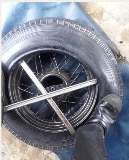
Dækmontering efter instruktionsbogen ifølge Bjarne Larsen.
