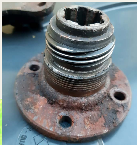
Skive/kulskive -udrykkerleje De grove gevind er til speedometerdrevet.
