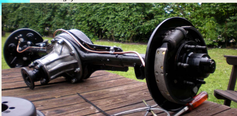
Samlet bagtøj med renoverede bremser.
