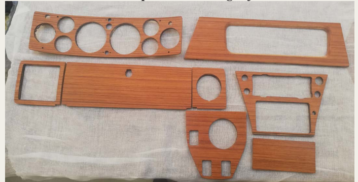
2 x klarlak, matslibning med korn 320 og finish med vaseline.
