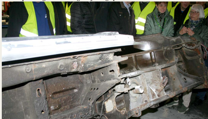
Siden af en VW Transporter, som skåret op, så man kan se hvordan reparationsdelene bedst kan laves.
