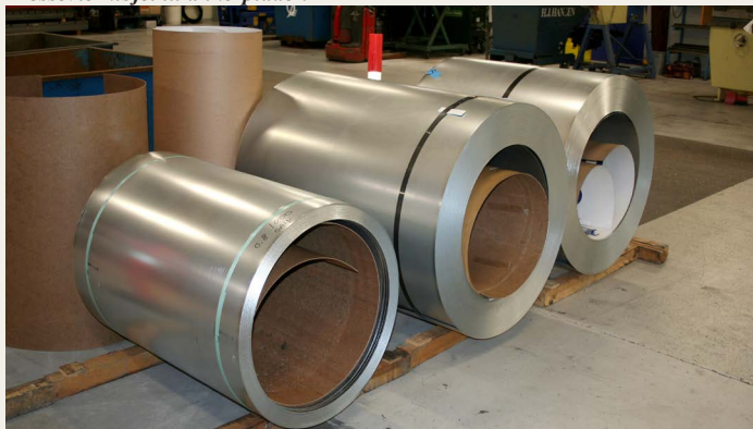
„Coils“ - store ruller med stålplade i de kvaliteter og tykkelser, der anvendes i produktionen. De fleste af pladerne er galvaniserede. På det sidste billede bliver pladerne rettet ud og klippet i håndterbare størrelser.
