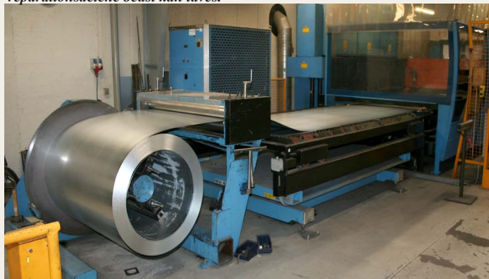
„Coils“ - store ruller med stålplade i de kvaliteter og tykkelser, der anvendes i produktionen. De fleste af pladerne er galvaniserede. På det sidste billede bliver pladerne rettet ud og klippet i håndterbare størrelser.
