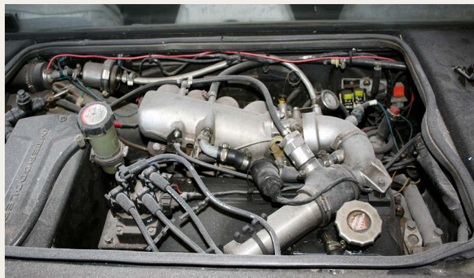
„Murenaens“ 2,2 L 4 cylindrede centerplacerede turbo-motor.
