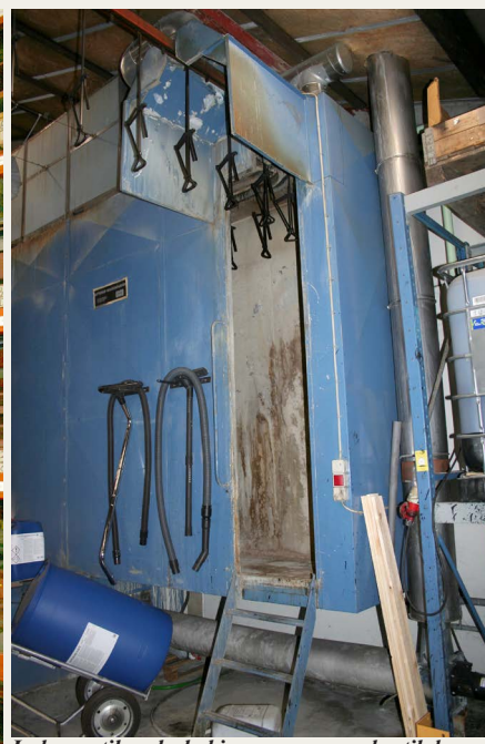
Indgang til malerkabine, som anvendes til de forholdsvis få dele, som ikke fremstilles af galvaniseret plade.
