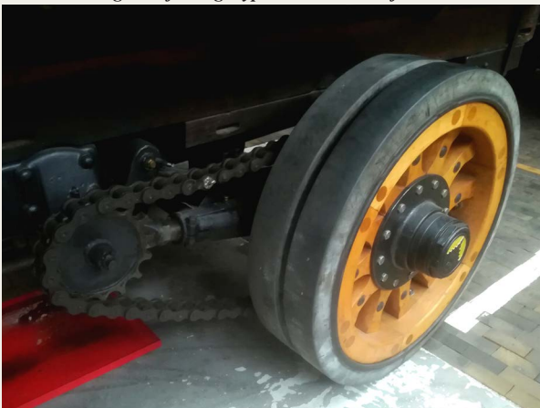
Engang var lastvognshjul bygget i træ med fast gummi og transmission var via kædetræk.
