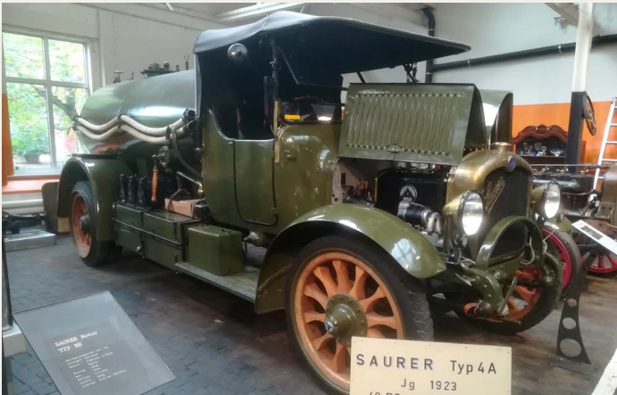
Tankvogn årgang 1923 - Type 4A - benzinmotor på 40 hk.
