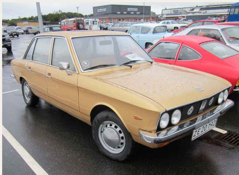
I Aars sås denne NSU/VW K70. VWs første model med forhjulstræk, vandkøling med motor i front.
