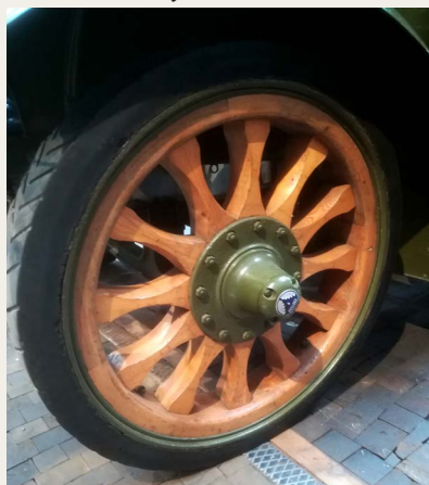
Engang var lastvognshjul bygget i træ med fast gummi og transmission var via kædetræk.
