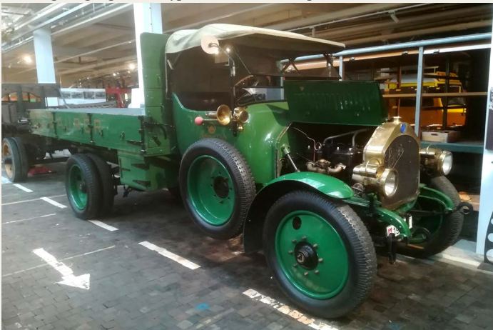
Lastvogn årgang 1917,- Type 3TC - benzinmotor 5,3 L 30 hk.
