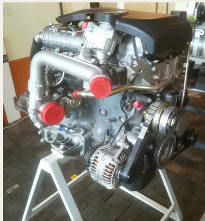
1960 Radarvogn et af mange typer militærkøretøjer. Udstillede dieselmotorer: FPT 4 cyl. 3.0 L 110-185 hk.
