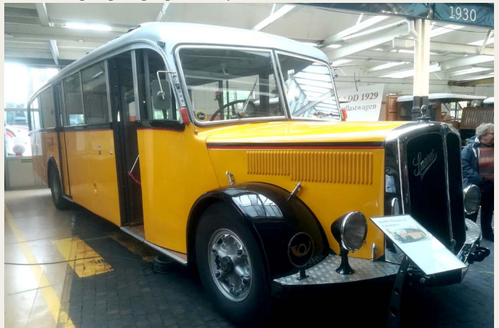
Bus årgang 1948 - Type Postauto 4 LC - 6 cyl. dieselmotor 7.9 L 135 hk.
