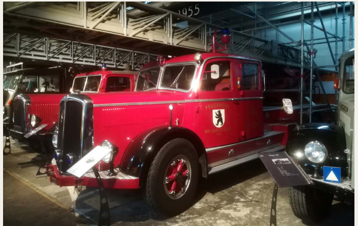
Brandbil/stigevogn årgang 1955 6 cyl. dieselmotor 120 hk.
