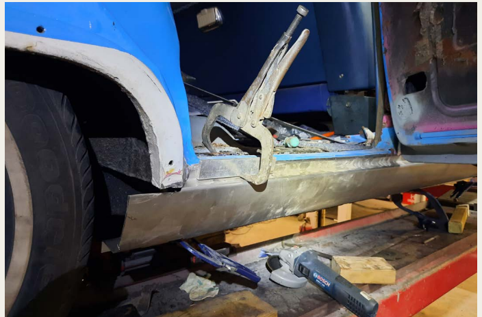
Karosseriarbejde på dørkanter og paneler.
