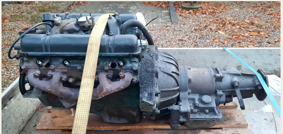
Motor - Buick 4.2 L Nailhead 264 V8 - og gearkasse - forberedelse til renovering.
