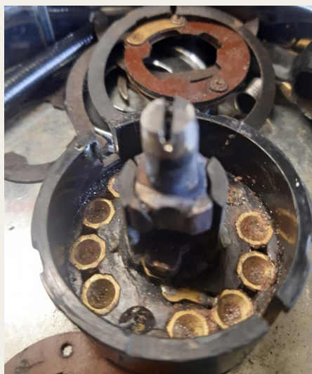
Tilpasningen af tændingsnøglens hus, så kontaktpunkterne passer.
