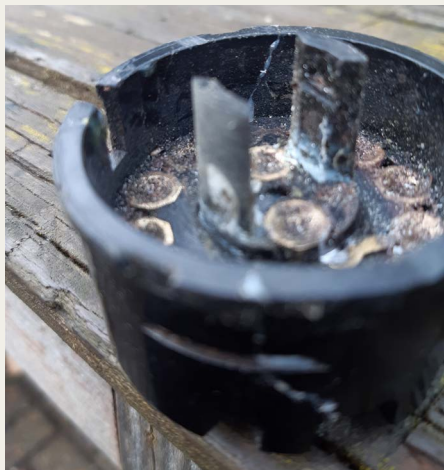
Tændings-/lyskontakten er limet sammen under pres for at limning kan holde. De to midterste tapper er limet sammen med stifter, som er boret ind i materialet, for at imødegå, og øge brudstyrken sidevejs.
