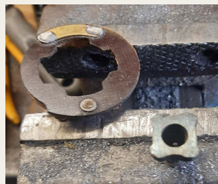
Reparation af kontakt broen, som styrer høj/lav ladning samt positionslygterne / nær og fjernlys.
