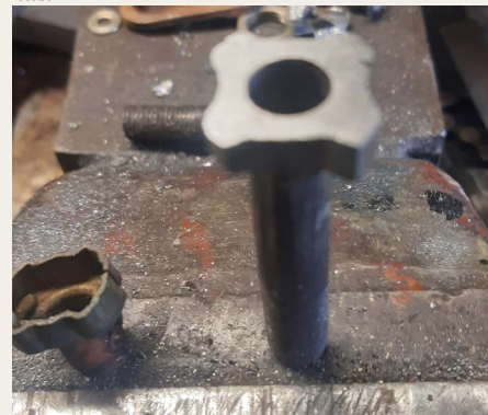
Et forsøg på at lave et nyt tændingsnøglehus fremstillet af en bolt, som er blevet udboret.
