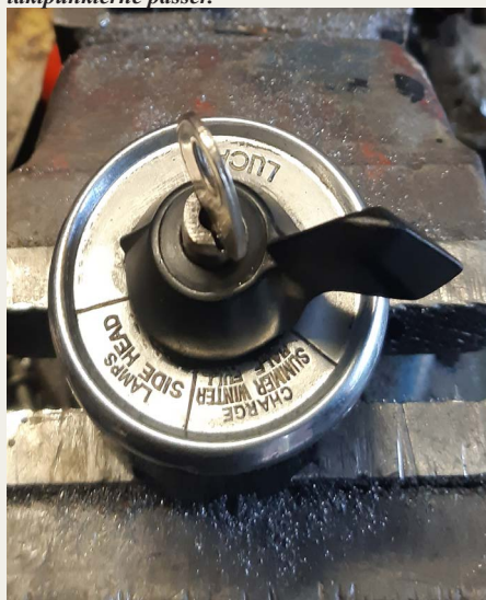
Samling af tændings- / lyskontakten samt afprøvning.
