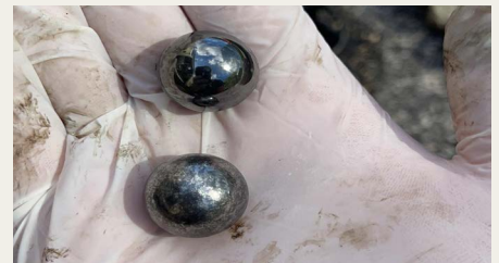
Slidte kugler fra CV-led
