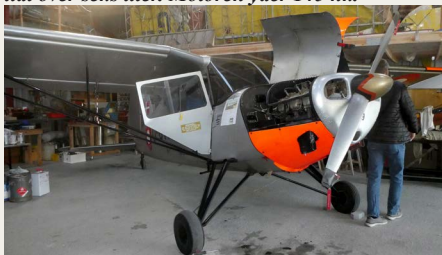
Den flotte KZ VII er lidt mindre end Chipmunk. Spændvidde/længde/højde er 9,60/6,5/2,1 meter, og det har en egenvægt på 535 kg – totalvægten er 860 kg. Topfarten er 249 km/t.
