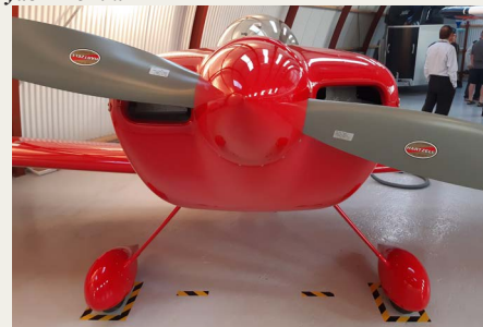
KZ VII motoren er en 6-cylindret luftkølet Rolls-Royce/Continental motor på lige under fem liter, og den yder 145 hk.
