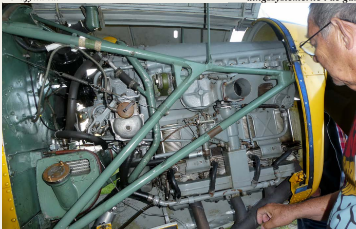
For os der er vant til at se på bilmotorer, vender sådan en flymotor helt for-kert: "bundkar" og krumtap vender opad, og "topstykke" vender nedad. Chipmunkens Gipsy Major Mk 10 motor har fire luftkølede cylindre på tilsammen lidt over seks liter. Motoren yder 145 hk.
