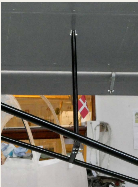
Den lodrette afstivning mellem vingen og den skrå afstivning hedder en „strut“, og det er den, der har givet navn til Veteranflyveklubben Strut Nordjylland.
