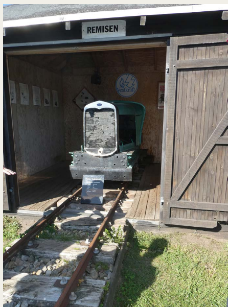
Pedershaab lokomotiv fra ca. 1930 bygget med motor, køler m.m. fra Ford.
