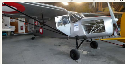
Det ældre KZ III har en spændvidde/længde/højde på 9,6/6,6/2,1 meter, og det har en egenvægt på 415 kg – totalvægten er 700 kg. Topfarten er 185 km/t. Dette fly har en 4-cylindret Cirius Minor række motor på 4 liter.
