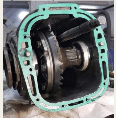
Den nye gearkasse i gang med at blive gjort klar til montering. Koblingshuset skiftes for at tilpasse gearkassen til en diesel motor
