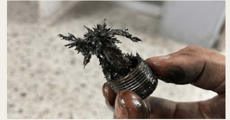
Her ses magnet bunddroppen fra den gamle gearkasse. Under normale forhold bør der ikke være nogle store metal spåner, i vores tilfælde var der ikke blot spåner, men store stykker metal fra vores bakgear.
