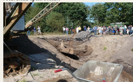
Pedershaab gravemaskinen "Sara" var i fin form, og med Michael Hanomag bag styrepinde og pedaler blev gravning med slæbeskovl demonstreret.
