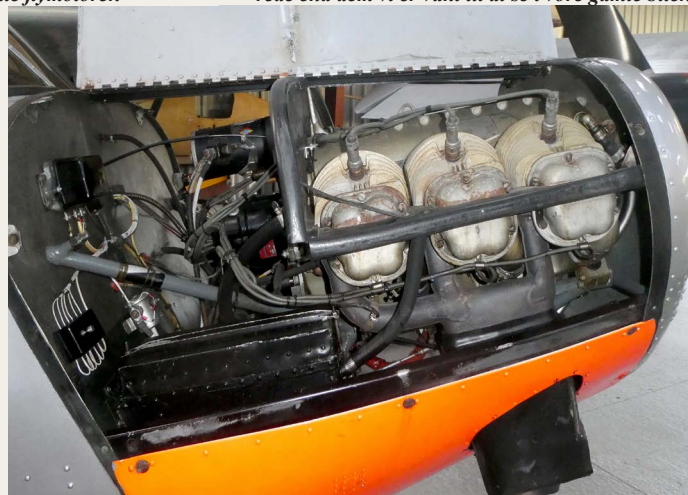
KZ VII motoren er en 6-cylindret luftkølet Rolls-Royce/Continental motor på lige under fem liter, og den yder 145 hk.
