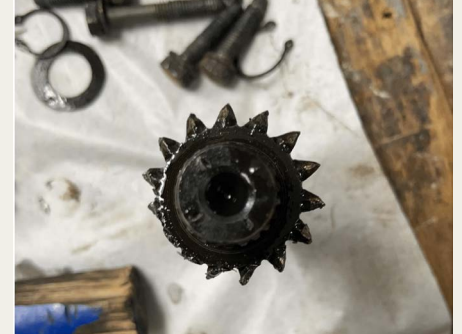
Bakgearet fra vores gamle gearkasse. Flere tænder på tandhjulet mangler helt eller delvist
