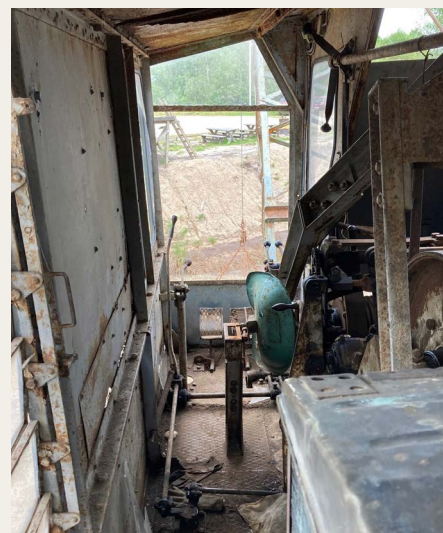
Interiør i køreklar Pedershaab gravemaskine. Ingen luksus og føreren sidder klos op ad de roterende spiltromler.
