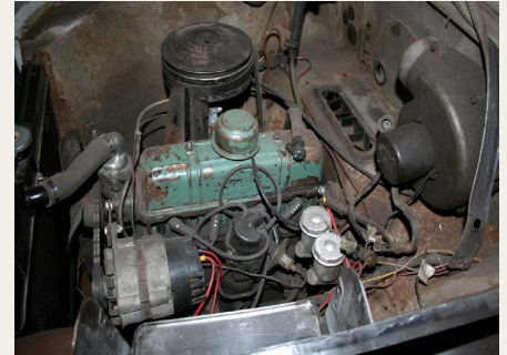
Motor isat efter renovering.
