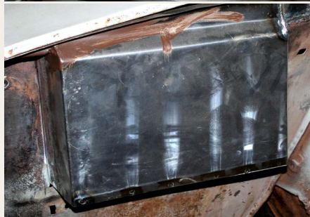
Batterikasse genopbygget m. hul t. affjedringstop.
