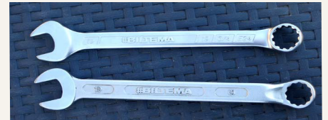
Dette er to styk 19 mm gæsel-/ringnøgler fra Biltema, og der står endda "Chrome Vanadium" på dem begge. Den dyre øverst kunne ikke anvendes til at afmontere starteren. Den billige nederst kunne godt.
