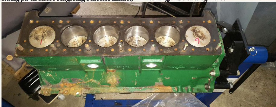
Den renoverede motorblok venter på at få en beskyttelsesplade på toppen, inden jeg går i gang med at rengøre, slibe og male i en lidt anden grøn nuance.
