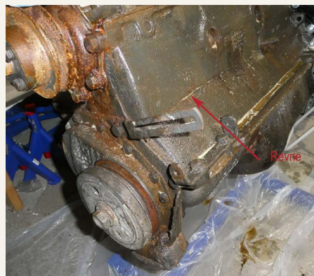
Selv efter det værste skidt er vasket af motoren er revnen rimelig tydelig
