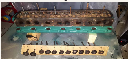
Nu er topstykket blevet malet og venter bare på, at ventilerne bliver monteret.
