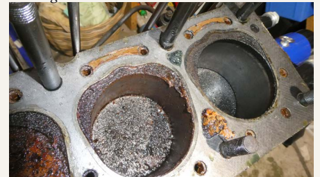
Og man kunne godt forstå, at det havde været vanskeligt at få køling i den bagerste del af motoren. Der skulle have løbet kølevand gennem de to trekantede huller mellem cylinder nummer fem og cylinder nummer seks.
