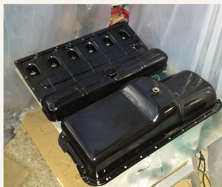
Sidedæksel, ventildæksel og bundkar er blevet rengjort, slebet og malet.
