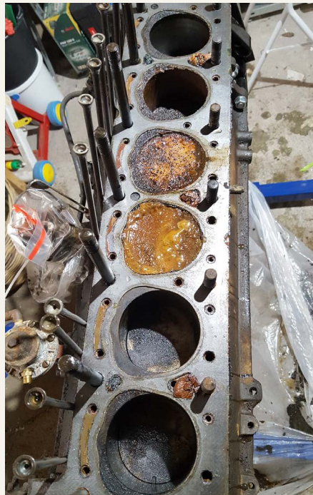
Da toppen kom af motoren, kunne man tydelig se, at toppakningen havde været kaput ved cylinder nummer tre og fire.
