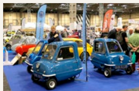
Peel P50 - 49 cc DKW motor - nu med Honda motor
