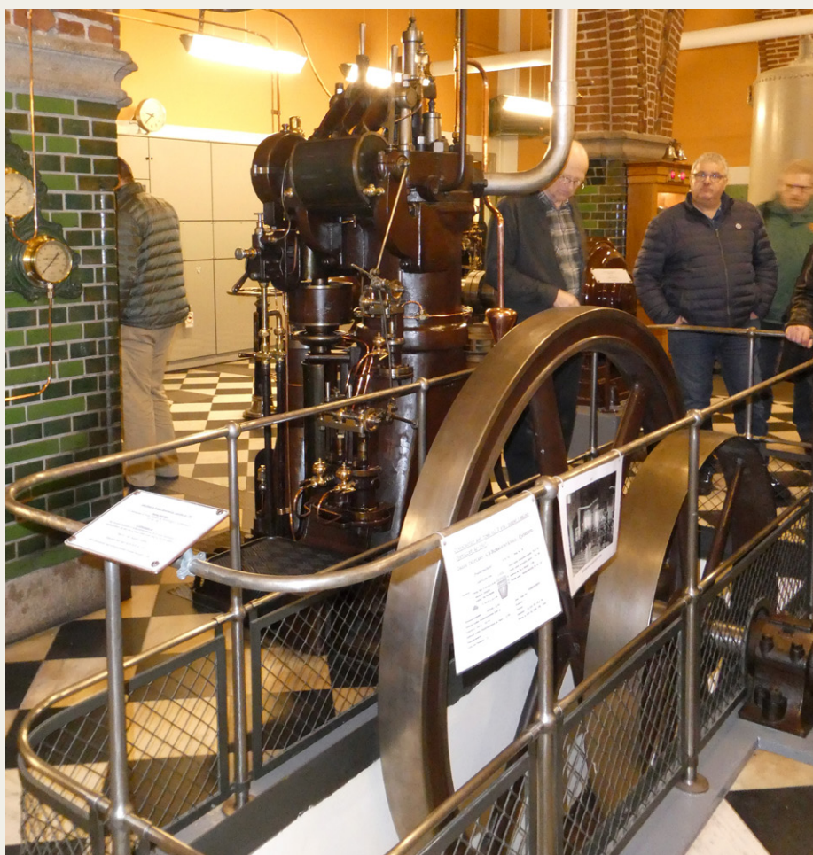
Her er den så: B&W Dieselmotor Nr.: 58. Encylindret dieselmotor med ca. 25 hk. Motoren er bygget og opstillet i 1907. Taget ud af drift omkring 1955 og med succes genstartet i 2003.
