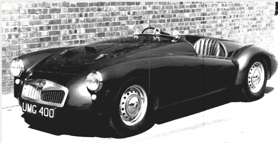
Den første MG med et MGA lignende karrosseri er denne MG EX176, som er bygget på et MG TD Chassis.
