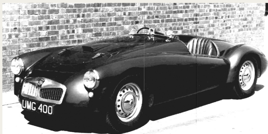
Den første MG med et MGA lignende karrosseri er denne MG EX176, som er bygget på et MG TD Chassis.
