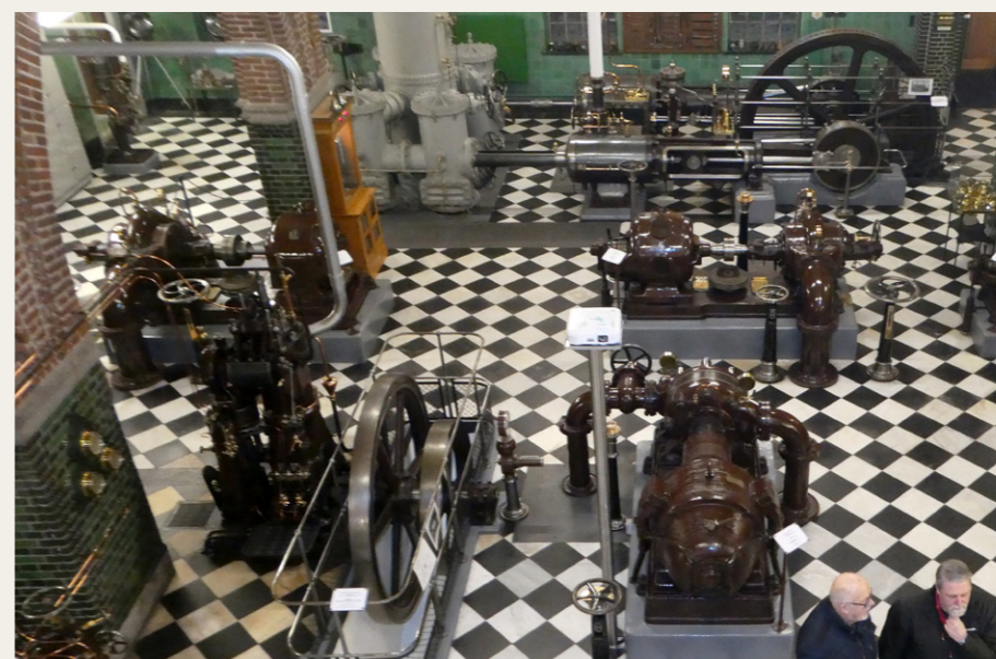
Et kig ud over maskinrummet. I baggrunden ses den to-cylindrede dampmaskine fra 1893. Foran den har vi en af de første eldrevne pumper fra 1921 og nederst til højre en nyere og kraftigere eldrevet pumpe fra 1939. Til venstre ser vi B&W Nr.: 58 - den fine dieselmotor fra 1907.
