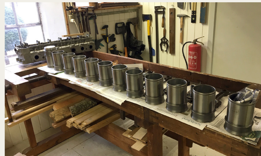
Det kan godt virke lidt uoverskueligt med 12 sæt stempler og foringer på houlbænken.
