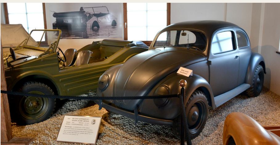
Museet har også denne tidlige udgave af en Volkswagen Typ 97 „Kommandeurwagen“. Bilen trækker på alle fire hjul, og den har en stor del af undevognen til fælles med Typ 166 „Schwimmwagen“.
