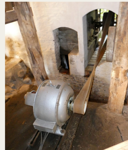
Fra 1921 til 1995 trak vandmøllens turbine en jævnstrømsdynamo, som leverede 110 Volt jævnstrøm til lamper i Møllegårdens stuehus og udhuse. Samtidig blev 55 åbne 2 Volt syrecellebatterier opladet, så, der også var strøm til rådighed, når møllen var stoppet.
