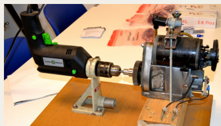
Stigs primitive, men effektive prøvestation til afprøvning af kondensatorer.
