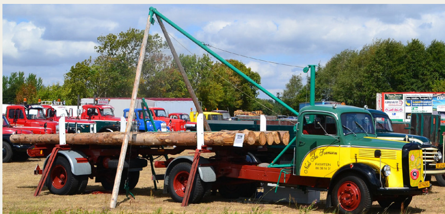
Fin Mercedes 312 med Indslev læsseaggregat, en simpel kran/spil til læsning af kævler, hvor kranarmen under brug skal understøttes af et par „telefonpæle“ af træ.
