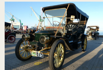
Et af de meget specielle køretøjer er denne Stanley Model 70, som drives af en dampmaskine.
