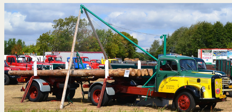
Fin Mercedes 312 med Indslev læsseaggregat, en simpel kran/spil til læsning af kævler, hvor kranarmen under brug skal understøttes af et par „telefonpele“ af træ.
