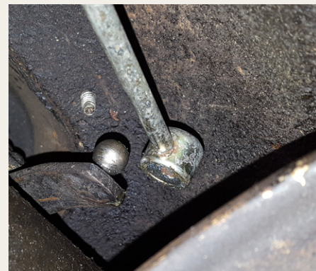
Og helt som forventet var den gamle forbindelsesstang hoppet af ved gearstangen.
