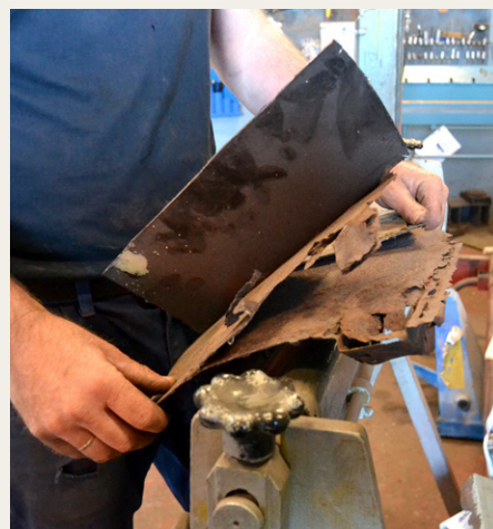
John viser hvor mange lag karosseriplade, der kan være i bunden af en Morris 1000, inden den får en ny bund.
