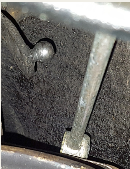
Her ser man tydeligt, at forbindelsesstangen har mistet forbindelsen med gearstangen.
