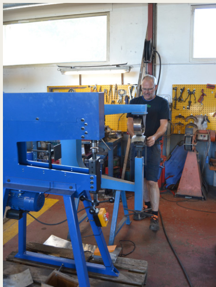
Her ses John ved det „engelske hjul“, som kan forme plader i alle retninger og foran en nyindkøbt mekanisk hammer.
