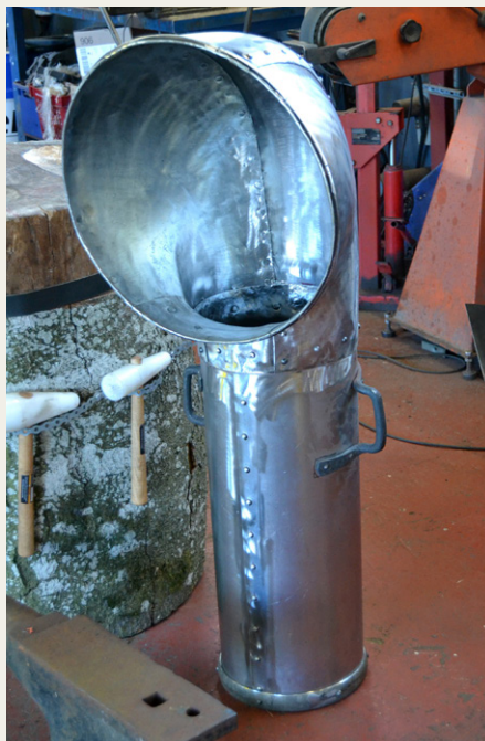
Her ses så den såkaldte dorade, som mange genkender fra de gamle sejlskibe. Et stort stykke arbejde at få sådant en formet og nittet sammen, og alt på den gammeldags måde - se det er håndværk.
