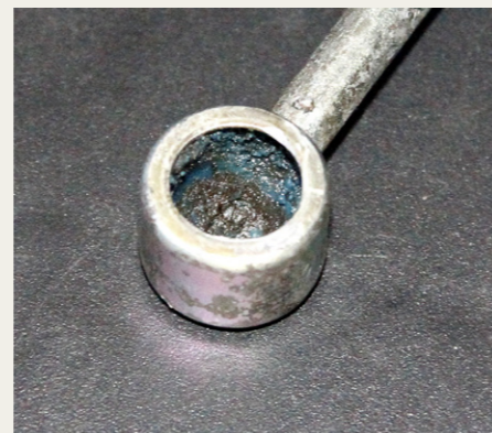
I den anden ende er der stadig lidt tilbage af plastbøsningen, men det ser ikke for godt ud.
