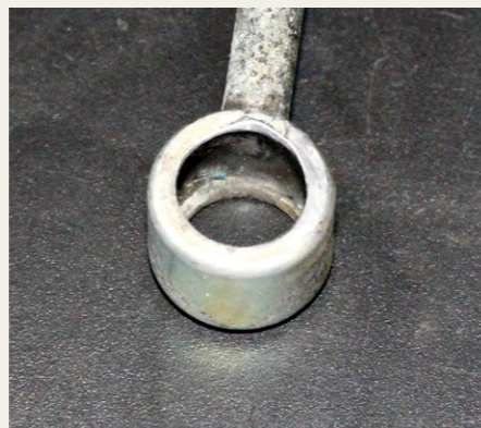
Som man tydeligt kan se, er plastbøsningen helt væk i den ene ende.
