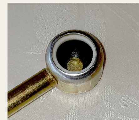
Den nye forbindelsesstang er designet en smule anderledes end den gamle. Der for eksempel brugt andre materialer til foringen.
