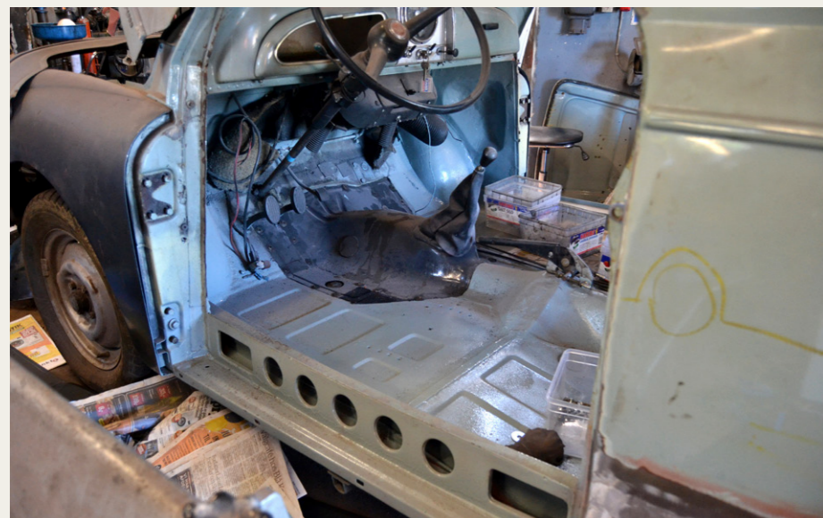
Opbygning af bund og paneler på en Morris 1000.
