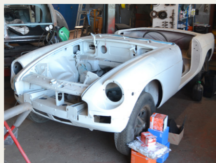
MG-karosseri, grundet og klar til at blive malet og monteret.
