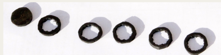
Komponenterne til den „nye“ bøsning bærer tydelig præg af de værktøjer, der var tilgængelige, men det betyder heller ikke så meget. De indvendige spidser bliver hurtigt slidt af, og hvis der ellers bare er gummi nok, vil det udfylde den plads, der er til rådighed.
