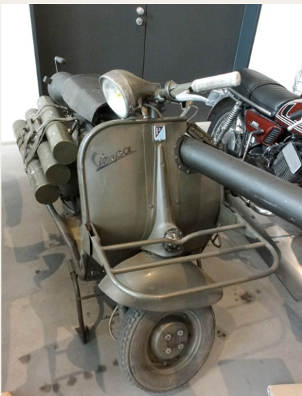
Vespa 145 Scooter ombygget til det franske militær og bevæbnet med 75 mm panserværnsrakettudstyr.
