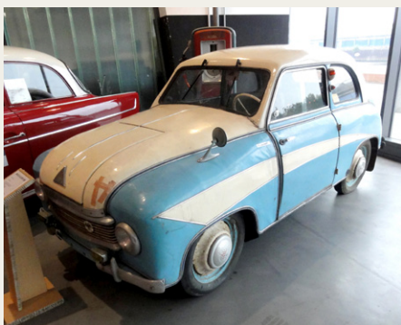
1950 Lloyd LP 300 Kleinwagen med 10hk to-cylindret motor. På grund af materialeknaphed blev karrosseriet opbygget i krydsfiner overspændt med kunstlæder, ligesom ujævnheder blev udlignet med et filtlag. Bilen blev vittigt omtalt som „Leukoplast-Bomber“.
