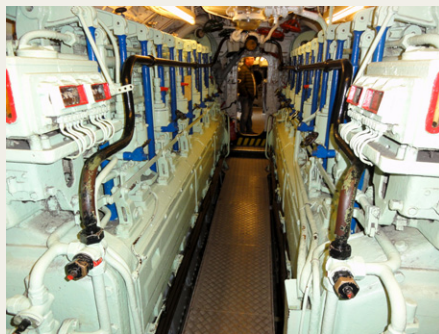
I maskinrummet midtskibs dominerer to MAN dieselmotorer på i alt 2.800 hk. Herudover findes to elmotorer på i alt 750 hk.
