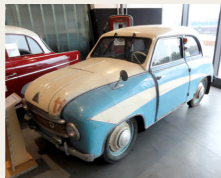
1950 Lloyd LP 300 Kleinwagen med 10hk to-cylindret motor. På grund af materialeknapphed blev karrosseriet opbygget i krydsfiner overspændt med kunstleder, ligesom ujævnheder blev udlignet med et filslag. Bilen blev vittigt omtalt som „Leukoplast-Bomber“.
