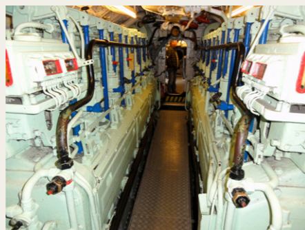
I maskinrummet midtskibs dominerer to MAN dieselmotorer på i alt 2.800 bk. Herudover findes to elmotorer på i alt 750 bk.
