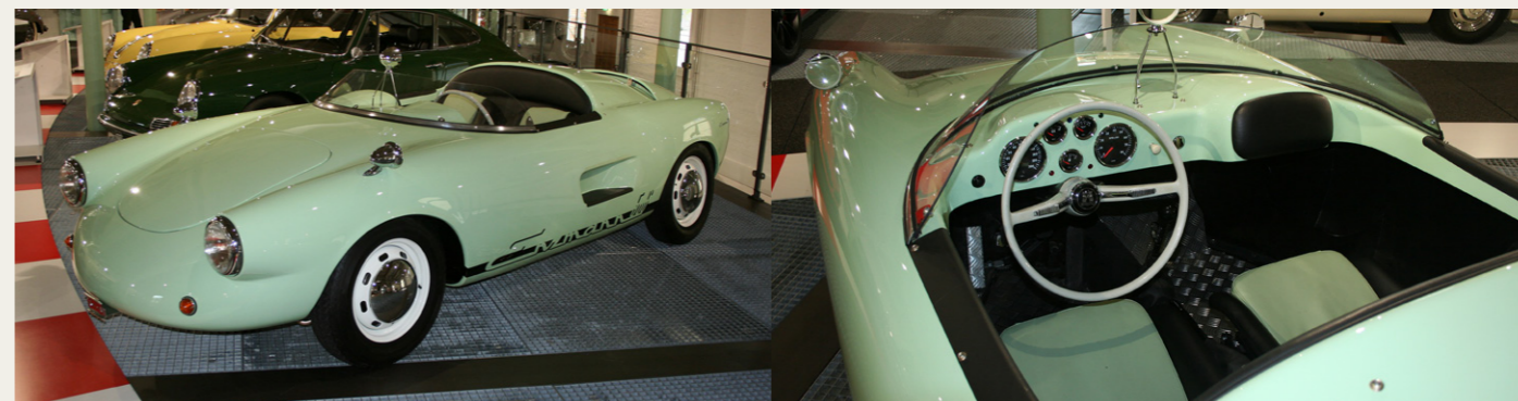
Enzmann 506 fra 1960. Enzmann var en schweizisk producent, som fra 1957 til sidst i tresserne købte nye Folkevogne, og udskiftede hele karrosseriet med et glasfiberkarrosseri. Motoren var som udgangspunkt en standard VW motor, men det var forholdsvis enkelt at montere en Porsche 356 motor
