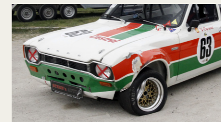
Der var flere købere, der erfarede, at kantsten og betonbarrierer ikke var særligt eftergivende. Ud over de synlige skader på skærm og fælg var der også et odelagt forhjulsophæng og formodentlig noget såret stolthed.
