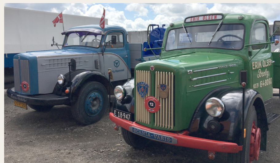
To fine Scania Vabis fra 1956-57: L51 (4-cylindret) og L71 (6-cylindret). Det er tydeligt at se forskellen på længden af „snuden“
