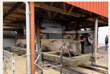
Via drivremme trak Laura denne store sav, som dagen igennem savede store planker.
