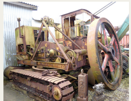
Bag den store hal ligger et af de mange fremtidige projekter, endnu en gravemaskine fra Pedershaab Maskinfabrik. Der skal vist bruges rigtig mange timer, for den er graveklar
