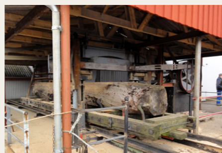
Via drivremme trak Laura denne store sav, som dagen igennem savede store planker.
