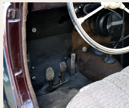
Pedalarrangement i Hanomag'en. Ved siden af speeder sidder aktivering til selvstarteren, og oppe til venstre sidder trykarrangementet til smøring af styretøj.
