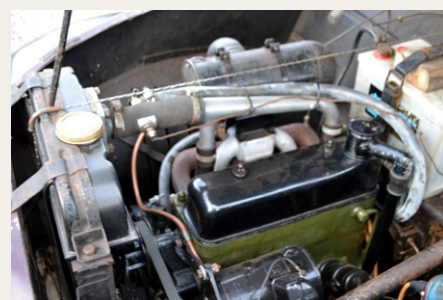
Motoren i Hanomag'en er en 1,3 liter sideventilet rækkemotormed en effekt på 32 hk.
