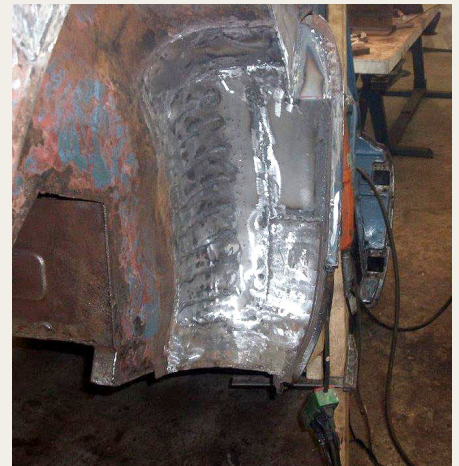
Store dele af skærmene og inderskærmene måtte rekonstrueres med nye krumme pladesektioner.
