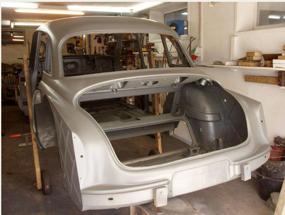
Så er karrosseriet endelig nået til det stadie, hvor maleren kan rykke ind.
