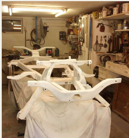
Den renoverede chassissramme er her klar til maleren, som også er Bert Holst.
