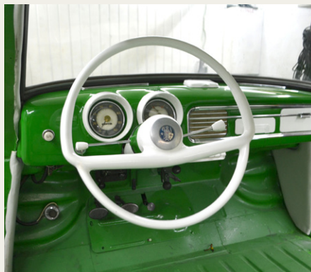
Det specielle rat er til gengæld Wartburgs helt egen opfindelse, og det må være designet til at give bedre plads til benene under ind- og udstigning. Andre bilmærker har løst samme problem med flade rat.
