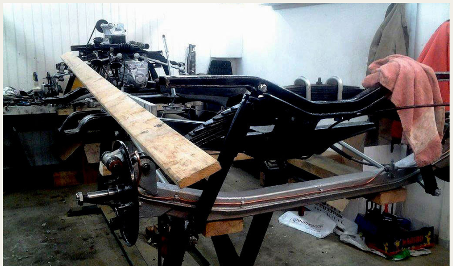
Den færdigerestaurerede chassissramme bliver monteret med motor, hjulophæng og bremses inden karrosseriet bliver monteret. Ophbygningen med den tværvendte bladfeder kendes igen fra førkrigs DKW biler.
