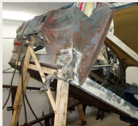
Et hjemmelavet stativ giver en meget bedre arbejdsstilling, når der skal svejdes på den nederste del af karrosseriet.
