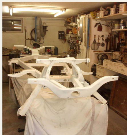
Den renoverede chassissamme er ber klar til maleren, som også er Bert Holst.
