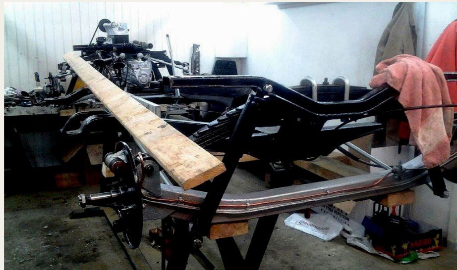
Den færdigerestaurerede chassissamme bliver monteret med motor, hjulophæng og bremsen inden karrosseriet bliver monteret. Opbygningen med den tværvendte bladfeder kendes igen fra førkrigs DKW biler.
