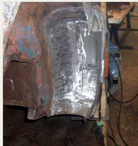
Store dele af skærme og inderskærme måtte rekonstrueres med nye krumme pladesektioner.
