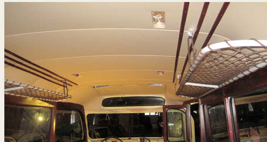
Indendørs er der monteret helt ny loftsbeklædning og fine bagagenet.
