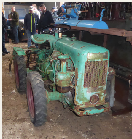
I en af ballerne, som var fyldt med en masse ikke renoverede maskiner, fandt vi denne lille sjove traktor. I følge maskinskiltet er der tale om en Holder Type A10 fra 1957. Den lille traktor har firhjulstræk og knækstyring.
