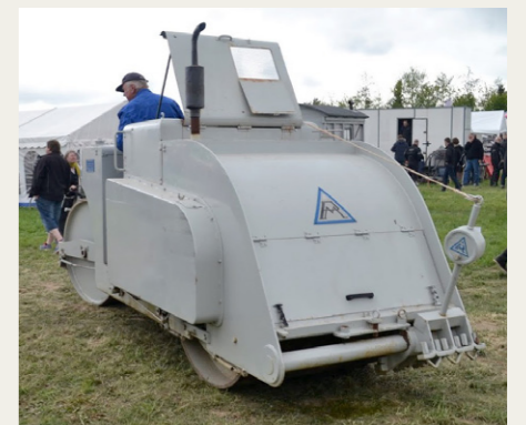
Gammel tromle fra Pedershaab Maskinfabrik. Byggeår 1950, model TA-7 og har en 3 cyl. Ruston motor. Har kørt for Karlebo Kommune fra 1950 til 1980, hvorefter den blev renoveret i 1998.
