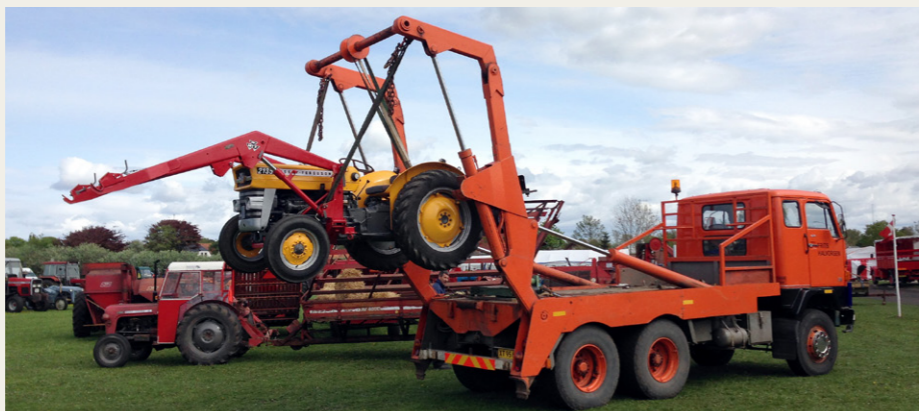
Volvo FB88 6x6, der tidligere har været anvendt til at transportere og nedpløje kabler for Frits Halvorsen, men opbygningen kan også bruges til løft af en traktor. Traktoren er en Massey Ferguson 2135, industriudgaven af en 135.
