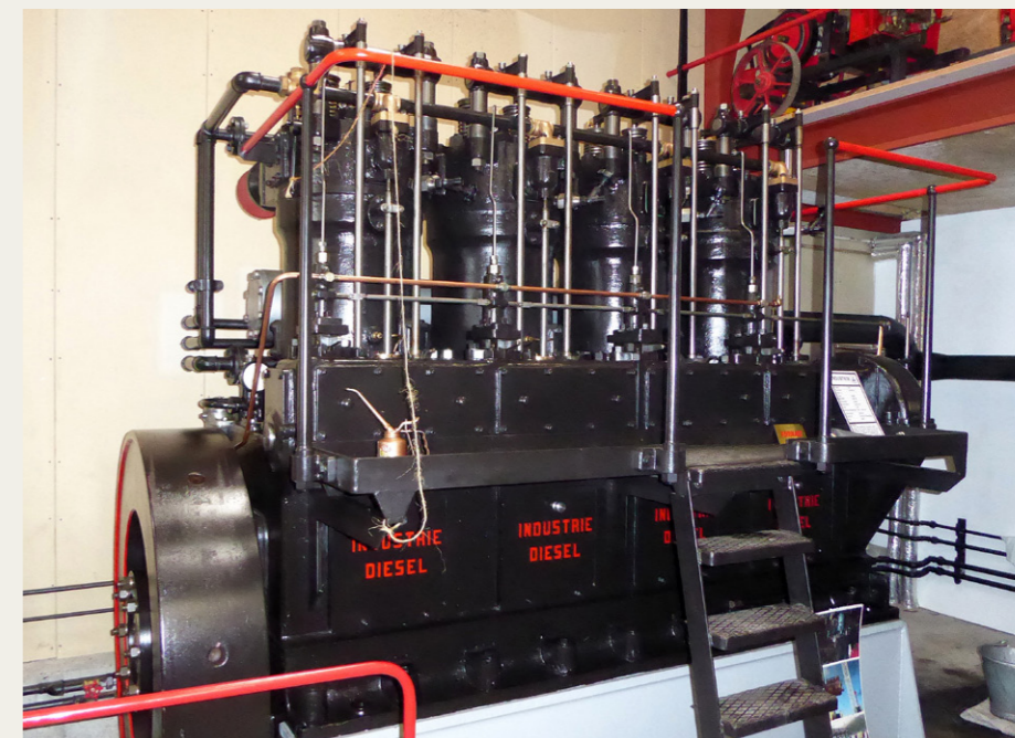
Denne fine „Industrie“ diesel motor har en fortid i den hollandske coaster „Sandtiet“, som senere endte i Marstal under navnet „Anne Birthe“. Motoren, som har et slagvolumen på næsten 100 liter, yder 200 hk.
