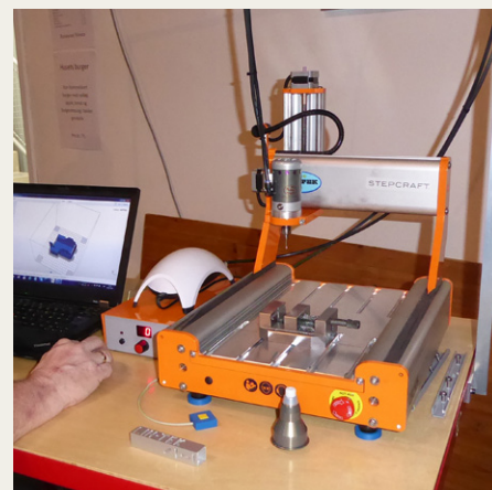
På en af standene tilbød man små værktøjsmaskiner til hobbybrug. Denne CNC styrede fræser arbejder i mange forskellige materialer.
