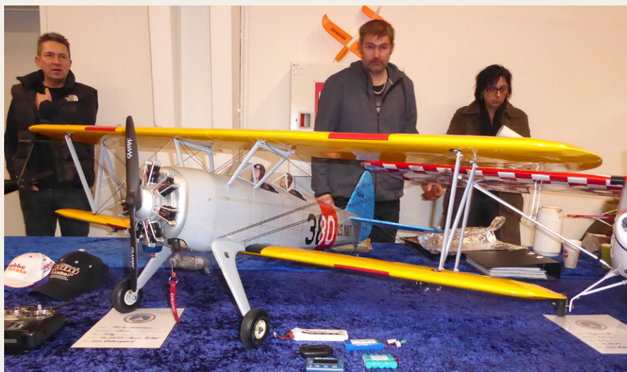
Viborg Modelflyveklub udstillede flere modelfly, blandt andet denne PT-17 Stearman, som har en spændvidde på hele 180 cm, og alligevel vejer den kun 7 kg. Motoren er en 26 ccm firtaktsmotor.
