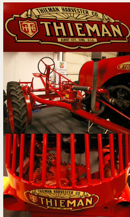
Simpelt styreaggregat som dog nok ikke er så tungt at arbejde med endda, da traktoren står på ét forhjul.
