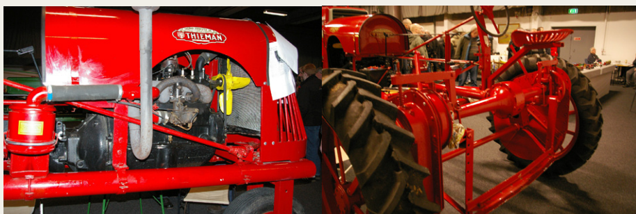
Drivlinen fra Ford A, dvs. motor, gearkasse, bagtøj og bagbremser var standard leverancen i Thieman traktoren, når denne købtes med motor og transmission. En kraftig udveksling til baghjulene opnåedes med kædetræk, som på de første modeller var åbne og derfor ikke helt ufarlige at bevæge sig i nærheden af.
