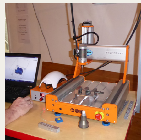
På en afstandene tilbød man små værktøjsmaskiner til hobbybrug. Denne CNC styrede fræser arbejde i mange forskellige materialer.
