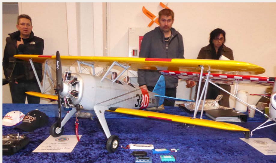
Viborg Modelflyveklub udstillede flere modelfly, blandt andet denne PT-17 Stearman, som har en spændvidde på hele 180 cm, og alligevel vejer den kun 7 kg. Motoren er en 26 ccm firtraktsmotor.
