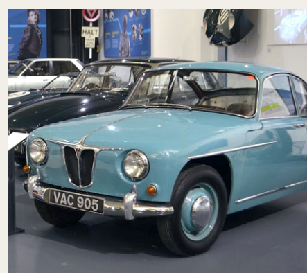
Rover T3 med gasturbine og 4-hjulstræk fra 1956. Turbinen ydede 110 hk ved 52.000 o/min.
