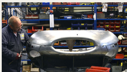
Der laves også hele fronthjelme i aluminium til Jaguar type E hos British Motor Heritage.
