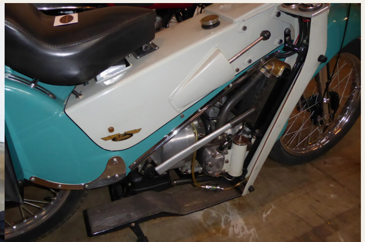
Klaus Berthelsen, som ses bagerst til venstre i billedet, havde en Velocette LE 200 fra 1960 til salg i Fredericia. Det lange håndbremselignende håndtag på siden af motoren er et starthåndtag og gearstangen er monteret på siden af tanken.
