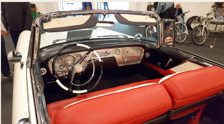
Midt på instrumentbrættet i Thorbens Caribbean ser man noget, der ligner en radio. I virkeligheden er det bare betjeningsdelen. Selve radioen, som er en stor sag med „full size“ radiatorer er placeret over fodrummet i passagersiden.
