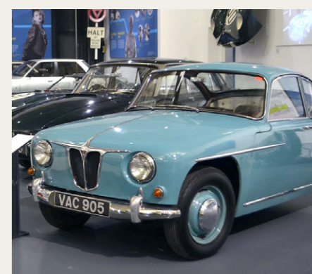
Rover T3 med gasturbine og 4-hjulstræk fra 1956. Turbinen ydede 110 hk ved 52.000 o/min.
