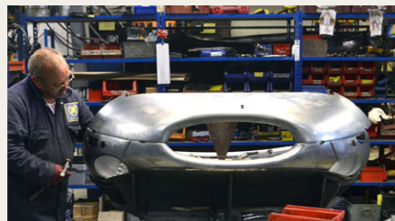
Der laves også hele fronthjelme i aluminium til Jaguar type E hos British Motor Heritage.
