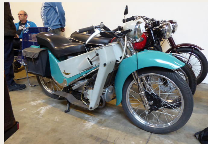
Klaus Berthelsen, som ses bagerst til venstre i billedet, havde en Velocette LE 200 fra 1960 til salg i Fredericia. Det lange håndbremselignende håndtag på siden af motoren er et starthåndtag og gearstangen er monteret på siden af tanken.
