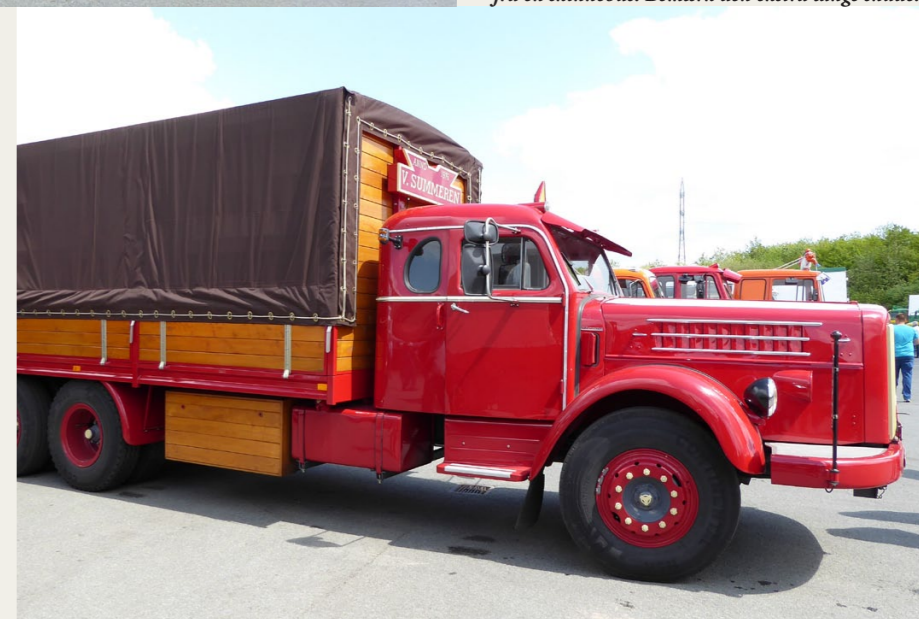
Scania Vabis LS85 med 8-cylindret rækkemotor fra en skinnebus. Bemærk den ekstra lange snude.
