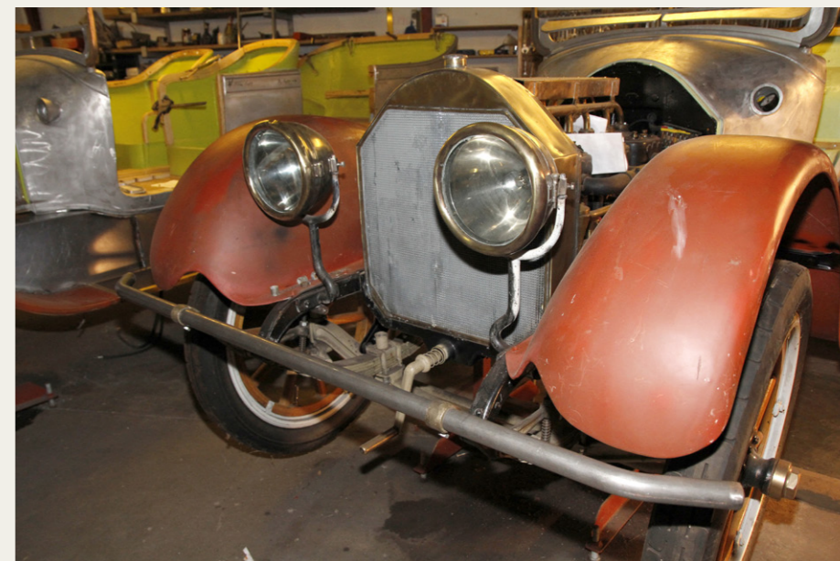
En af de ting, som er kommet til siden sidst, er kofangerne. Et simpelt bukket rør, som dog er fjedrende ophængt, så det giver lidt efter, hvis man kører på noget.
