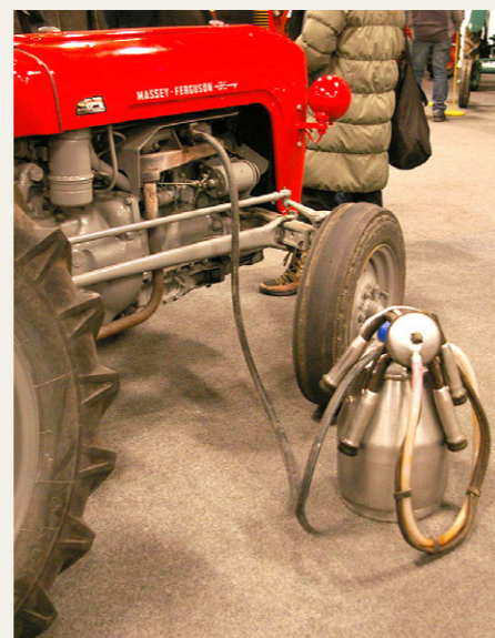
Sådan kunne man også skabe vakuum til at drive malkemaskinen.
