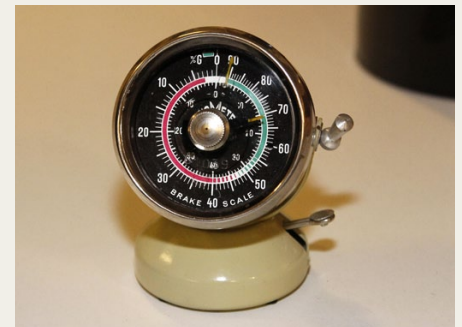
Et instrument til måling af friktion via en bremseprøve er et uundværlig værktøj for en bilinspektør.
