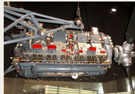
Mercedes-Benz V12 motor fra et Messerschmitt ME 209 jagerfly.
