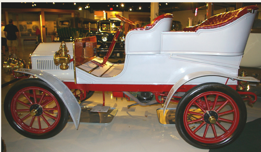
1904 Studebaker model C var den første benzindrevne bil fra Studebaker. Centermonteret 2-cylindret, 16HK, 2 gear og kædetræk. Bilen her menes at være det eneste eksisterende eksemplar af denne model. Det aftagelige tonneau karrosseri skiltes bag forsæderne og bagsædet således helt fjernes, hvorved der blev plads til fragt af mindre mængder gods.
