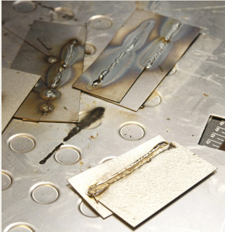
Nogle af aftenens svejseprover. Øverst er det almindelig karosseriplade og nederst er det galvaniseret plade, som er samlet med MIG-lodning.
