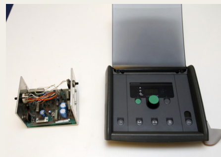
Elektronikken i svejsemaskiner før og nu. Og før er faktisk ikke så voldsomt mange år siden.
