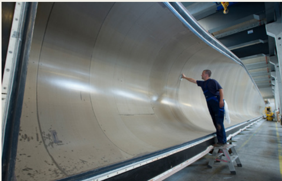
Overparten til en 52 meter støbeform renses og klargøres til den næste vinge.
