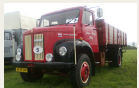
Flot Scania L50 med Nopa tippelad. Minder bortset fra farven meget om en lastbil jeg kan huske fra den lokale vognmand, da jeg var dreng. Med sin firecylindrede dieselmotor har en Scania 50 en meget anderledes lyd end de fleste andre lastbiler.
