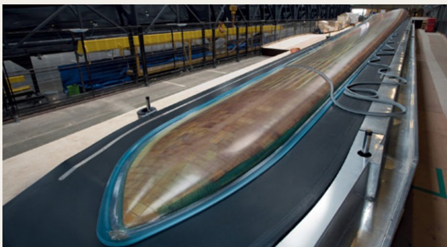
En 52 meter vinge ligger stadig i formens underpart. De firkanter stykker balsatræ, som er placeret mellem inderste og yderste lag glasfiber ses tydeligt gennem den gennemsigtige epoxy.
