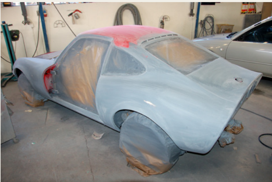
GT'eren er afmonteret, rustarbejde udført, grundingsprocesserne er næsten færdige
